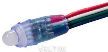
Герметичный (IP67) светодиодный модуль (1 RGB-светодиод 8 мм). Цвет свечения RGB. Угол свечения 120°. На проводе 50 шт, между модулями 80 мм. Питание 5В, мощность 0.3Вт. Диаметр модуля 12 мм.
