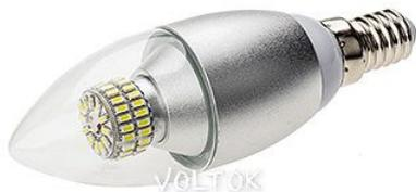
E14 светодиодная лампа "прямая свеча", замена ламп накаливания 40-60Вт. Корпус алюминий+стекло. Цвет БЕЛЫЙ ДНЕВНОЙ 4000-5000K, св. поток 530 лм, угол освещения 300°. Питание 100-240V AC50/60Hz, мощность 6Вт.
