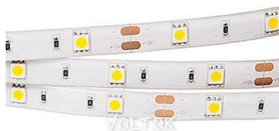
Герметичная лента LUX на белой плате, с силиконовым покрытием IP65 (защита от пыли и брызг), на скотче 3М. Цвет БЕЛЫЙ ХОЛОДНЫЙ 9000К, светодиоды smd 5060 150шт, катушка 5м. Питание DC 12V, макс.ток 3А, мощность 36Вт. Размеры WxHxL - 10x2.4x5000 мм.
