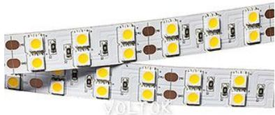
Гибкая лента LUX, 2 ряда, светодиоды smd 5060 (20 лм), 120шт/м (600шт на 5м), белая плата 15мм, скотч 3М. Цвет Цвет БЕЛЫЙ 5800-6500К. Питание 24V, макс. мощность 28.8 Вт/м (144 Вт на 5м), угол 120°, высокая цветопередача CRI>80. Размеры 5000x15x2мм. Мин.отрезок 50мм-6 светодиодов. Цена за 1м.
