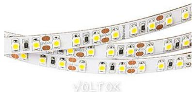
Гибкая самоклеющаяся светодиодная лента (на белом основании). Цвет свечения ТЕПЛЫЙ БЕЛЫЙ 3500К. Двойная плотность светодиодов, на 5 метров 600шт LED smd 3528. Питание 12V, мощность 42W, угол 120°. Цена указана за 1м. Ширина 8мм, высота 2.4мм
